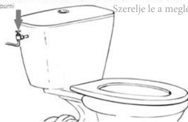
Appuyez sur le bouton pour enclencher l'abattant Nyomja meg a gombot a Wc ülőke felhelyezéséhez
